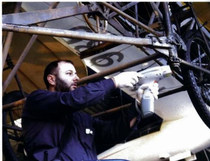
Markus Zraggen, métallurgiste à l'EMPA, utilise un spectromètre de masse à rayon X pour l'analyse préliminaire des pièces métalliques du Dufaux 4.
